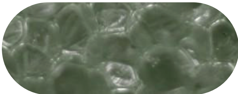
Рисунок 1. Ячеистая структура «PIR Плиты»®
